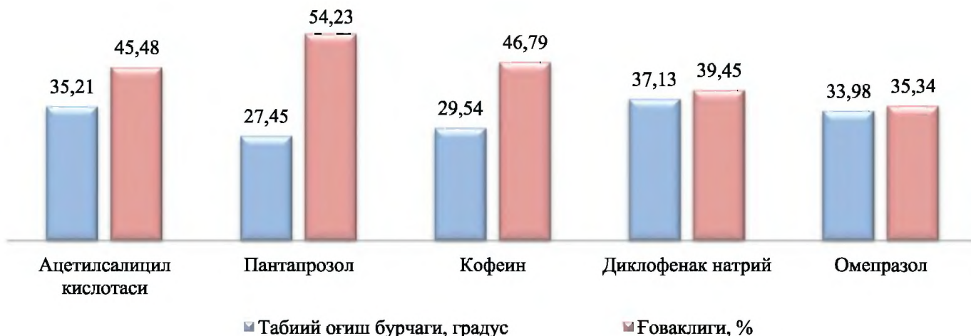
4-расм. Дастлабки хом ашёларнинг табиий оғиш бурчаги ва ғоваклилигини ўрганиш натижалари
